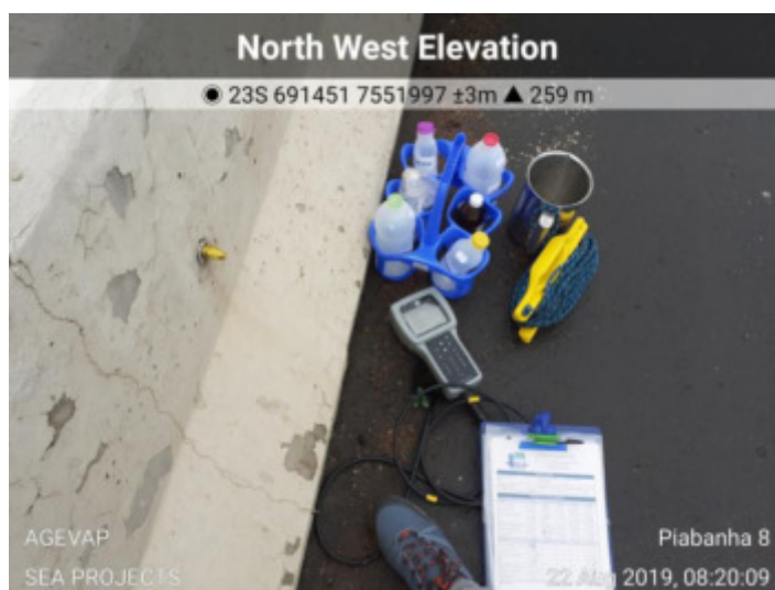
Figura 3.2-3: Frascaria, caneco inox e sonda multiparamétrica utilizadas na amostragem.
